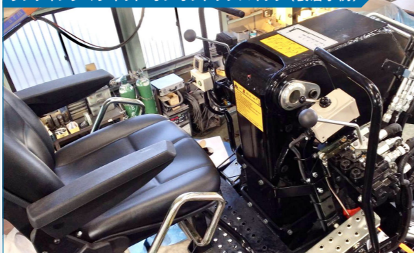
リフティングマグネット オンオフトップスイッチ (装着事例)
